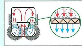
Geringe Staubbildung durch intelligente Luftführung. Alle Maschinen der 400er- und 600er-Serien, außer der haaga 475, sind mit zwei Spezialfiltern für feinen Staub ausgestattet. Innerhalb der Maschinen wird die staubhaltige Luft durch diese Filter gesäubert und in den Kehrkreislauf zurückgeführt. Der Bediener steht damit nicht – wie so oft – hinter der Kehrmaschine in einer dichten Staubwolke.
